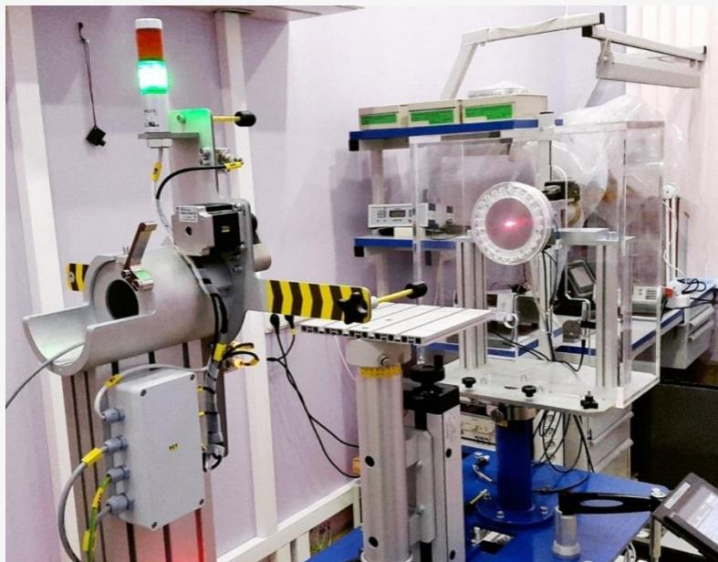
Формирование эталонного поля от источников подвижным блоком излучателя с использованием сглаживающих фильтров
