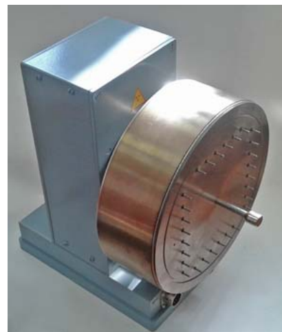
Генератор ИНГ-27 с 192-пиксельным \alpha -детектором
