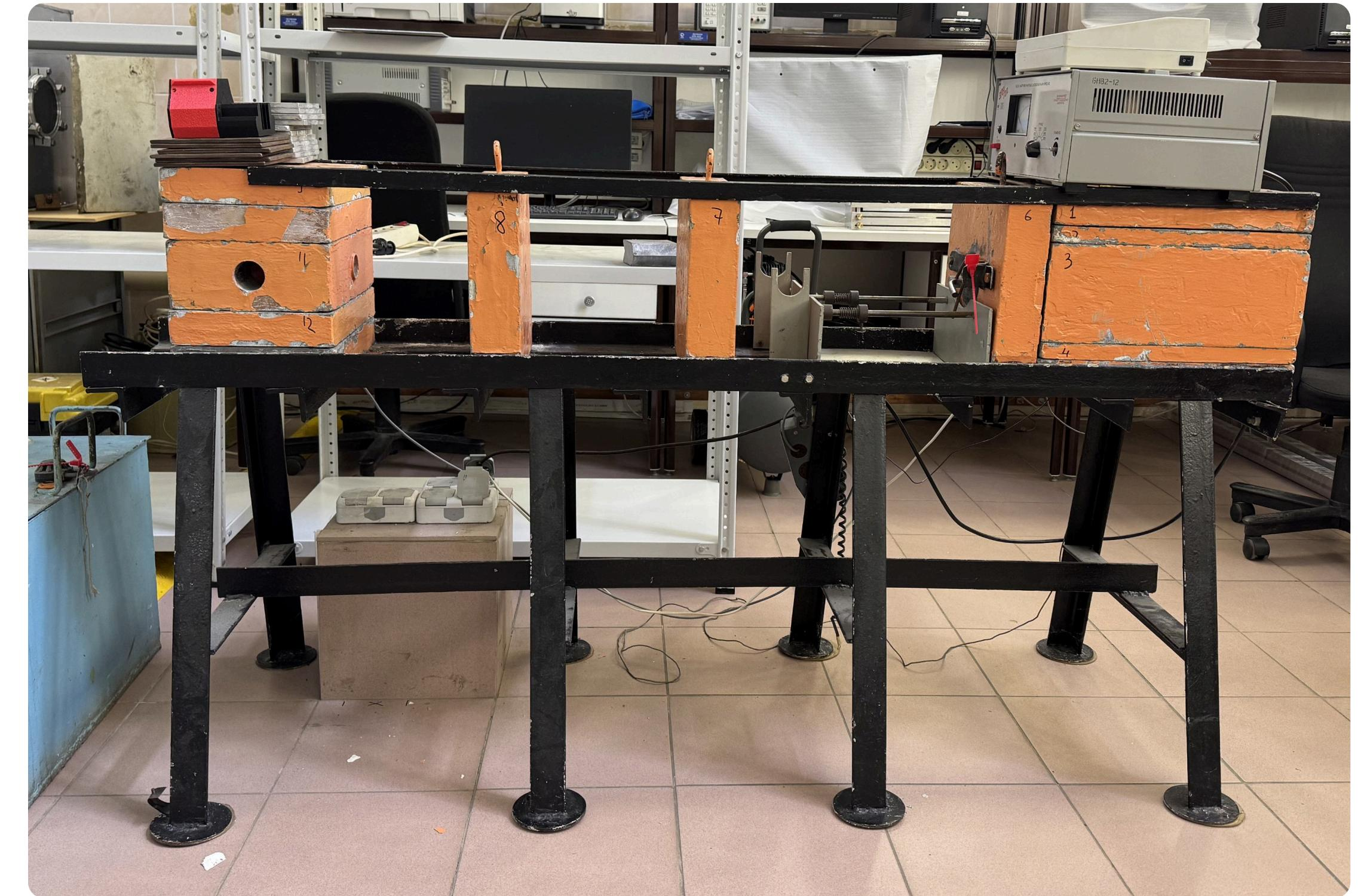
Сравнение размеров лабораторной установки по определению коэффициента поглощения (активность Cs-137  $3 \cdot 10^9$  Бк) с размерами разработанного спектрометра
