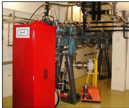
Установка для определения содержания ЯОДН с помощью фотонейтронов
