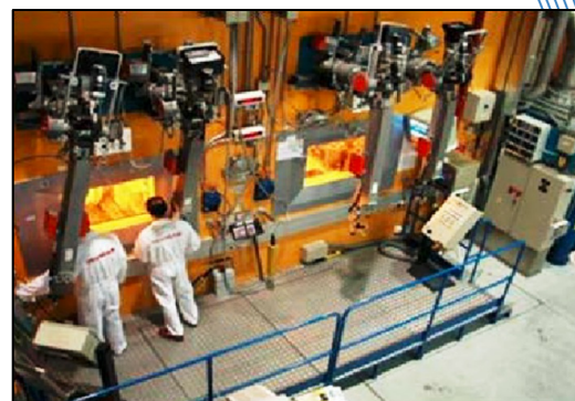
Горячая камера для выбуривания образцов РАО
