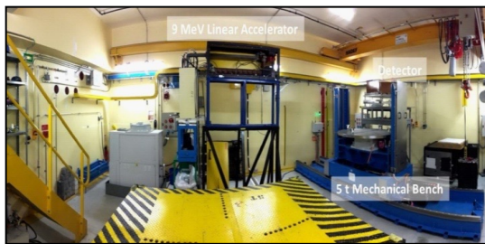
Установка с линейным ускорителем для «просвечивания» упаковок РАО
