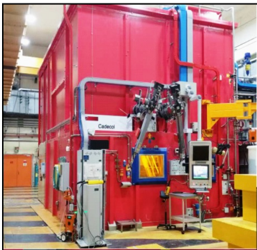
Горячая камера для резки контейнеров с РАО
