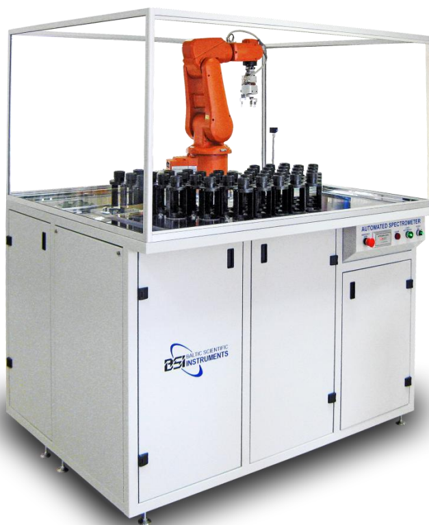
Рис. 1 Автоматизированный очг спектрометр для радионуклидного анализа
