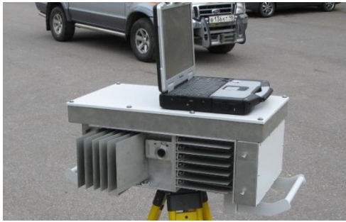
Рис. 2: Гамма-сканер СканС-Н»: Локализация ^{241}\text{Am} (5ГБк на 50м)
