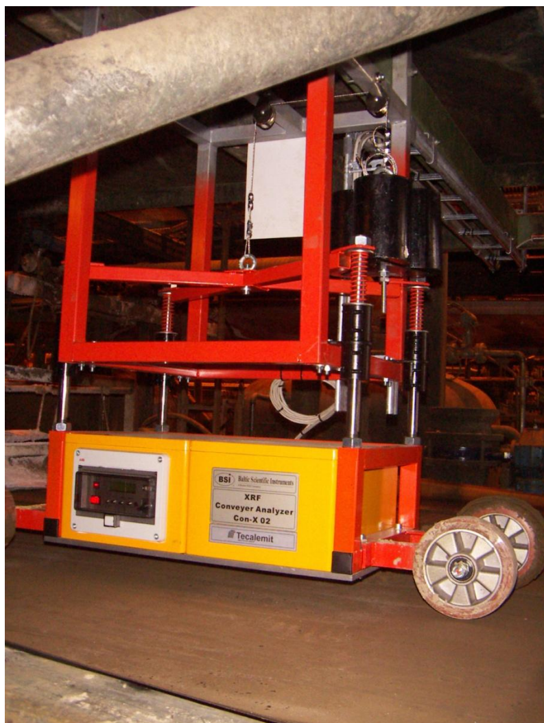
Рис. 1. Фото установки анализатора CON-X02 (Предприятие OMG, г. Коккола, Финляндия)
