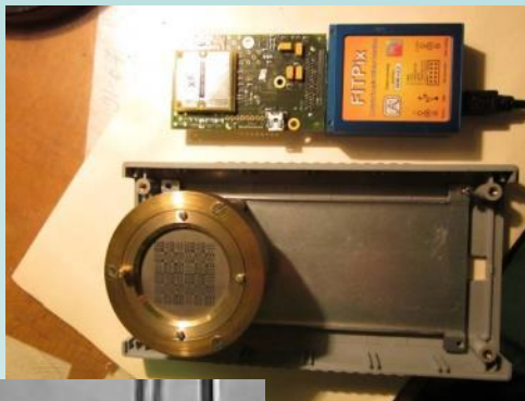
Детектор Медипикс2 с модулем связи FITPiX и блок кодирующей маски – основа камеры
