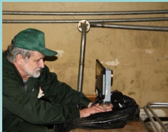
Детектор Медипикс2 с модулем связи FITPiX и блок кодирующей маски – основа камеры
