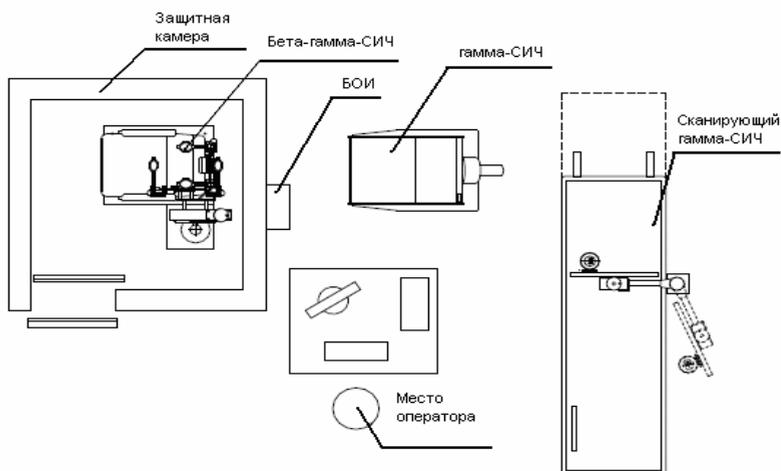
Рис.1. Измерительный комплекс «Экспертный бета-гамма-СИЧ».
