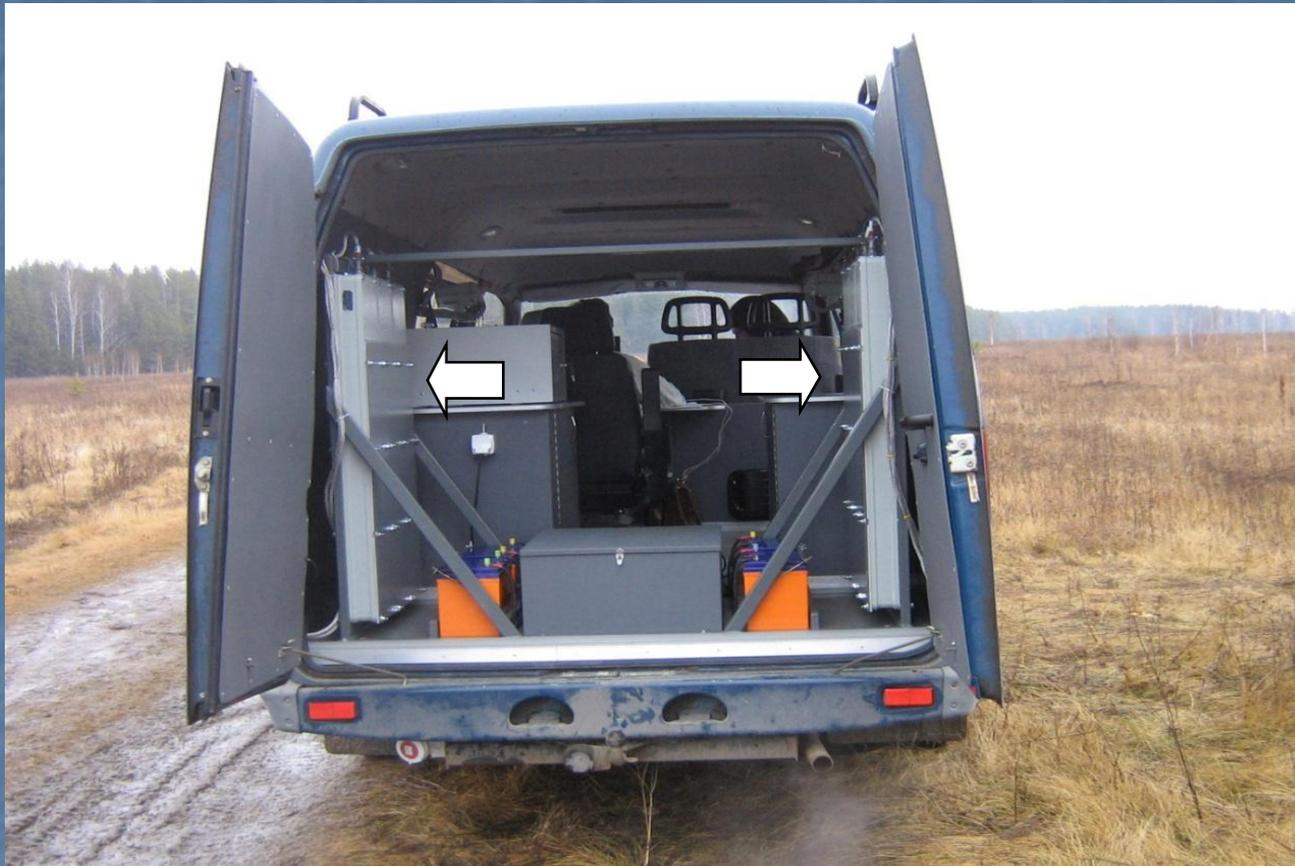
Счетный гамма-канал – основной для решения задач поиска и обнаружения. Высокая обнаружительная способность обеспечивается за счет большой площади чувствительной поверхности детекторов (около  $0,3 \text{ м}^2$  по каждому борту). Детекторы - на основе сцинтиллирующей пластмассы (показаны стрелками). Общее количество блоков детектирования – 6 шт. (по 3 шт. по каждому борту)
