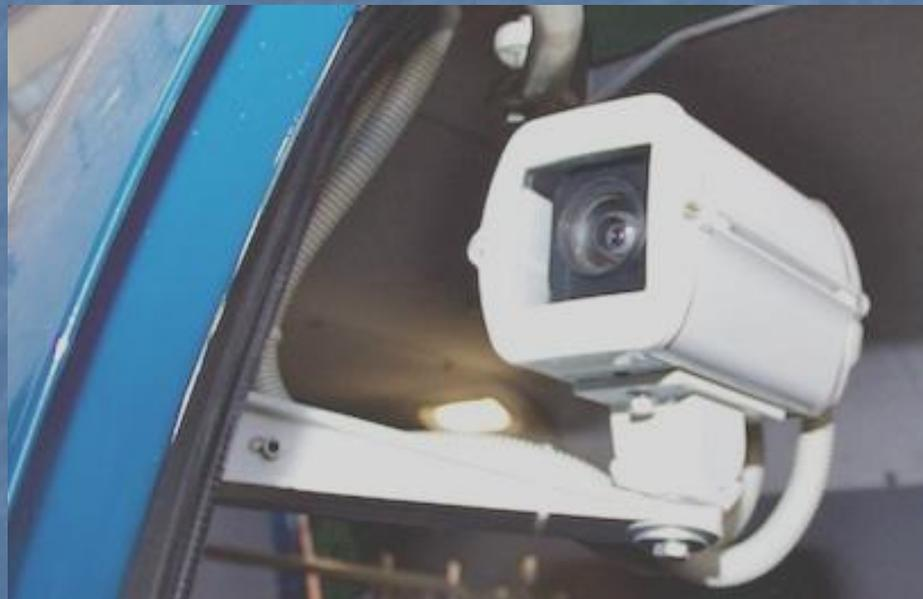
Видеоканал построен с использованием двух видеокамер Sony FCB-EX1000R, установленных по правому и левому бортам автомобиля.
