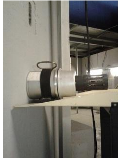
Сцинтилляционный гамма спектрометр с кристаллом NaI(Tl) диаметром 150 мм и высотой 150 мм и ФЭУ-167
