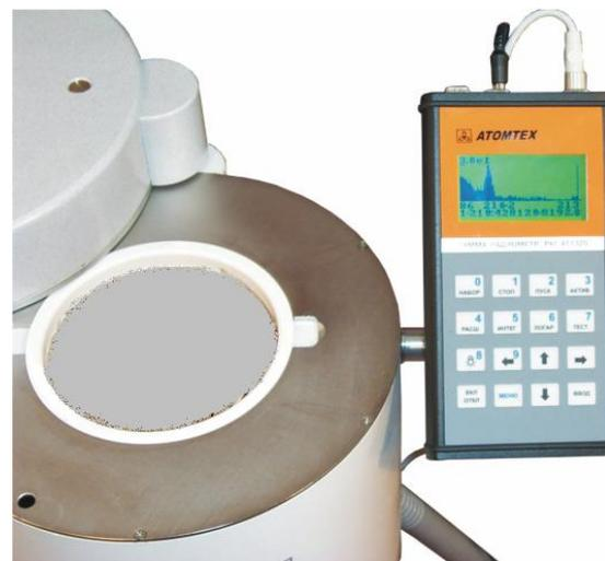
Радиометр предназначен для контроля содержания радионуклидов I-125, Tl-201, Tc-99m, I-123, In-111 и I-131 в сливе сточных вод учреждений здравоохранения и других организаций, использующих указанные радионуклиды
