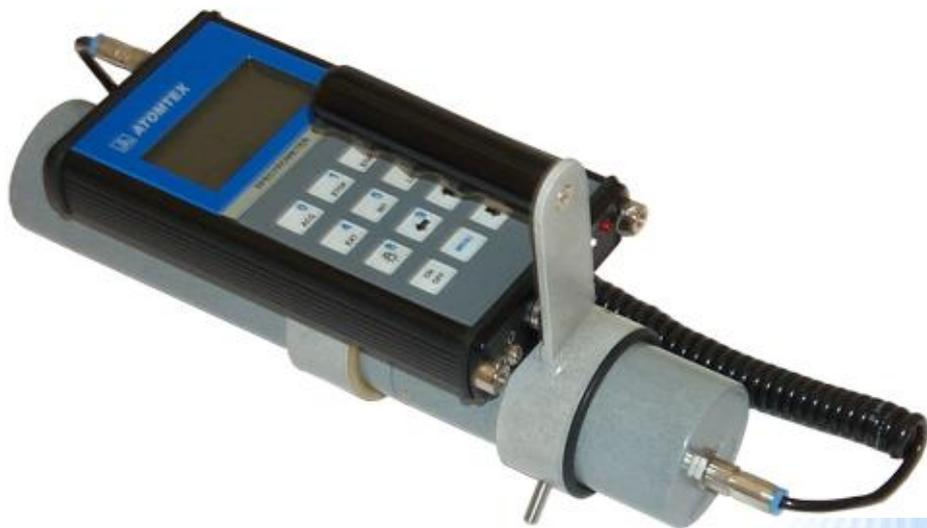
предназначен для поиска, обнаружения, идентификации радионуклидов, измерения энергетического распределения гамма-излучения, мощности амбиентного эквивалента дозы гамма-излучения
