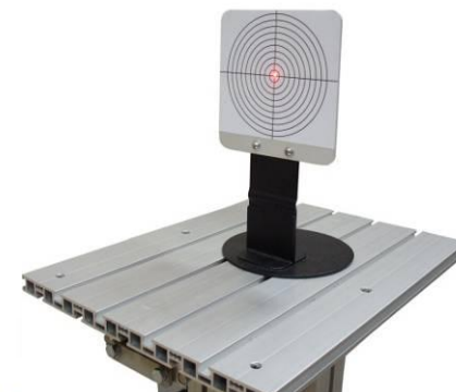
Мишень для проверки отклонения продольной оси калибровочного стенда
